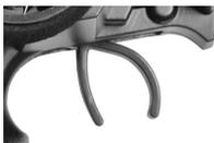
2. Guidare in avanti, spostare lentamente la leva di accelerazione/freno in direzione dell'impugnatura.
