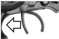
3. Guidare in avanti, quindi frenare (il veicolo rallenta, non decelera a ruota libera lentamente). Allontanare la leva di accelerazione/freno dall'impugnatura senza alcuna pausa.
