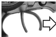
4. Guida in avanti, frenata, e retromarcia: Spostare senza interruzione la leva di accelerazione/freno dalla maniglia (frenare); se il veicolo si ferma, portare brevemente (1 secondo) la leva di accelerazione/freno in posizione di folle, quindi spostare la leva di accelerazione/freno dalla maniglia (il veicolo si muove ora in retromarcia)
