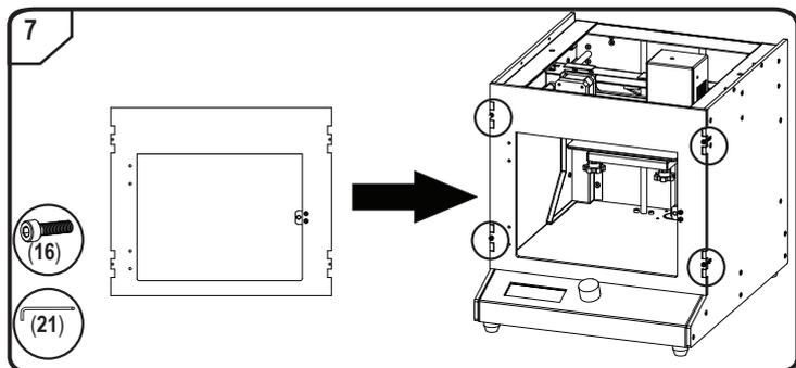
• **Passo 7:** Assicurarsi durante il serraggio delle viti (16) che le viti siano ruotate nei dadi, che vengono inseriti di volta in volta nei passi 2 e 4.
