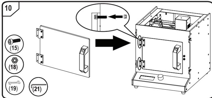
• **Passo 10:** Serrare la vite (15) dall'esterno con la chiave a brugola da 2,5 mm (21). Tenere fermo il dado (18) con il chiave fissa (19) dall'interno.
