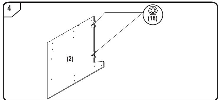
• Passo 4: Mettere un dado (18) nell'incavo del componente laterale destro (2).
