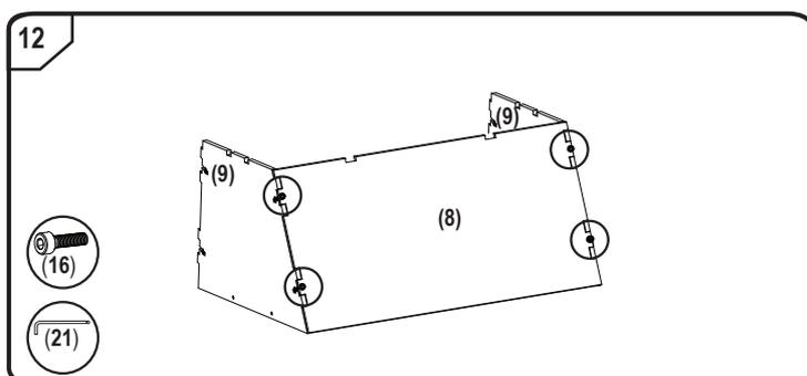
• **Passo 12:** Assicurarsi durante il serraggio delle viti (16) che le viti siano ruotate nei dadi, che vengono inseriti nel passo 12.
