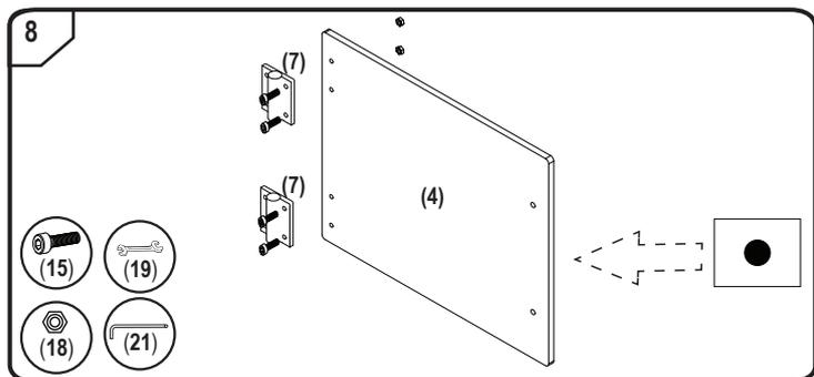
• **Passo 8:** Fare attenzione quando si fissa la cerniera, che il magnete ● si trovi sul lato posteriore della porta (4).
