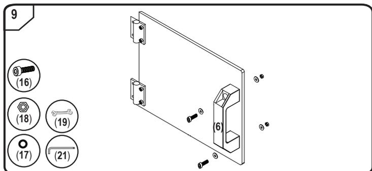
• **Passo 9:** Serrare la vite (16) con la chiave a brugola da 2,5 mm (21). Tenere fermo il dado (18) con la chiave fissa (19).
