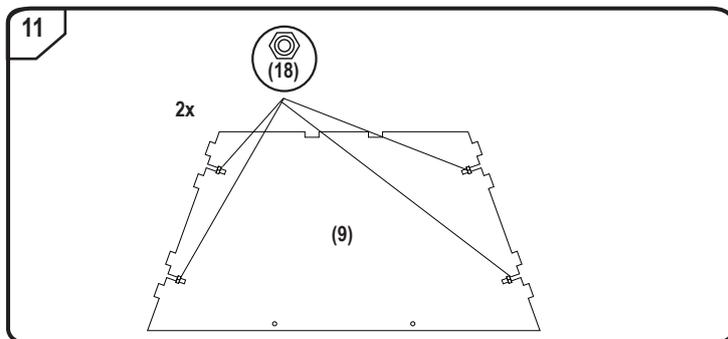
• **Passo 11:** Mettere un dado (18) nell'incavo del componente laterale (9).
