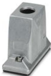
Custodia mobile HEAVYCON ADVANCE, B16, con bloccaggio a vite (esagono cavo) in acciaio inox, alluminio impermeabile, altezza 93,7 mm, con filettatura 1x M40, uscita cavo diritta, senza superficie; guarnizione conduttiva (caratteristiche EMC)
