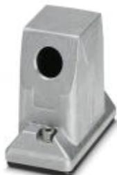
Custodia mobile HEAVYCON ADVANCE B10, con bloccaggio a vite (esagono cavo) in acciaio inox, alluminio impermeabile, altezza 93,7 mm, con filettatura 1x M25, uscita cavo laterale, senza superficie; guarnizione conduttiva (caratteristiche EMC)
