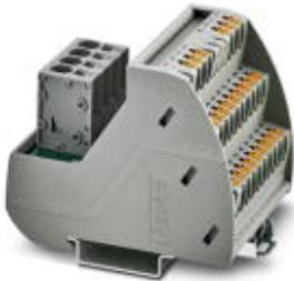
Modulo VARIOFACE con due barre equipotenziali (P1, P2) per la ripartizione del potenziale, per l'installazione su guide di montaggio NS 35. Larghezza modulo: 41,9 mm
