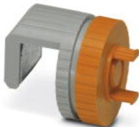
Il dispositivo di arresto opzionale offre alla bobina Rogowski una sede fissa su barre collettrici con uno spessore di 10 ... 15 mm. Durante l'installazione la custodia della bobina viene infilata sulla flangia del dispositivo di arresto e bloccata automaticamente.
