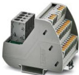
Modulo VARIOFACE con connessione Push-in e due barre equipotenziali (P1, P2) per la ripartizione del potenziale, per l'installazione su guide di montaggio NS 35. Larghezza modulo: 57,1 mm
