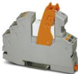
Modulo portarelè montato con connessione push-in, composto da: base relè, relè a contatto di potenza, modulo di segnalazione di stato e di soppressione dei disturbi a innesto e leva di fissaggio. Esecuzione contatti: 2 contatti di scambio. Tensione di ingresso: 12 V DC
