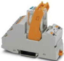
Modulo portarelè montato con connessione push-in, composto da: base relè, relè a contatto di potenza con durata supplementare e leva di fissaggio. Esecuzione contatti: 4 contatti di scambio. Tensione di ingresso 24 V DC
