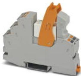
Modulo portarelè montato con connessione Push-in, composto da: base relè, relè a contatto di potenza, modulo di segnalazione di stato e di soppressione dei disturbi a innesto, leva di fissaggio. Esecuzione contatti: 1 contatto di chiusura. Max. corrente di inserzione fino a 130 A di picco, 80 A (20 ms) Tensione di ingresso 24 V DC
