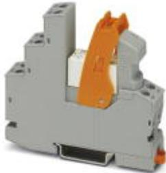
Modulo portarelè montato con connessione a vite, composto da: base relè, relè a contatto di potenza, modulo di segnalazione di stato e di soppressione dei disturbi a innesto e leva di fissaggio. Esecuzione contatti: 1 contatto di chiusura. Max. corrente di inserzione fino a 130 A di picco, 80 A (20 ms) Tensione di ingresso 24 V DC
