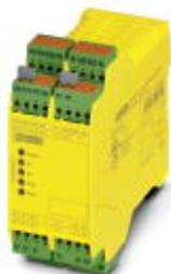
Modulo di sicur. per controllo per arresti d'emerg. e finecorsa ripari fino a SIL 3 o cat. 4, PL e secondo EN ISO 13849, attivaz. automatica o manuale, 3 contatti in chiusura, 1 contatto in apertura, 2 contatti in chiusura con ritardo alla diseccitaz. da 1,0 s fissi, morsetti con connessione a molla estraibili
