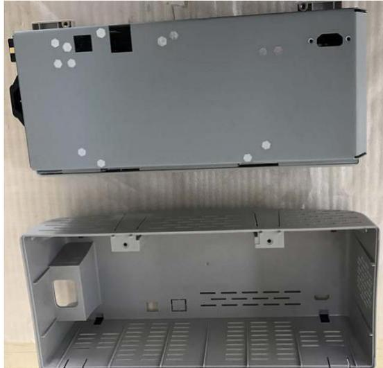
2. Rimuovere le viti dalla copertura metallica, e rimuovere la copertura metallica.
