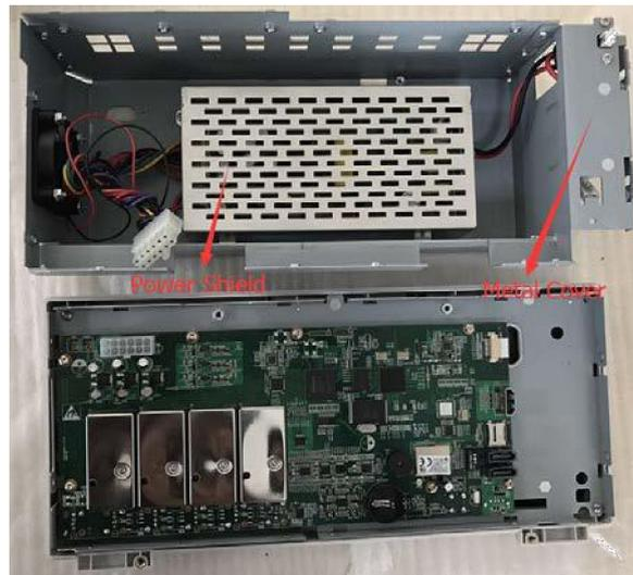
3. Rimuovere le viti dalla griglia dell'alimentatore e rimuoverla. Il fusibile è visibile sulla scheda dell'alimentatore. Sostituire con un fusibile avente le stesse caratteristiche.
