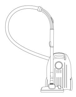
Una volta finito di aspirare, è possibile agganciare la bocchetta per pavimenti nel supporto nella parte inferiore del prodotto.
