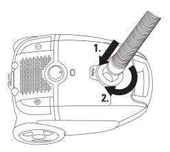
• Inserire l'estremità del tubo con le due sporgenze laterali nell'apertura di aspirazione e ruotare il tubo di ca. 30° in senso orario.
