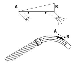
• Controllare la potenza di aspirazione con la levetta sull'impugnatura:
