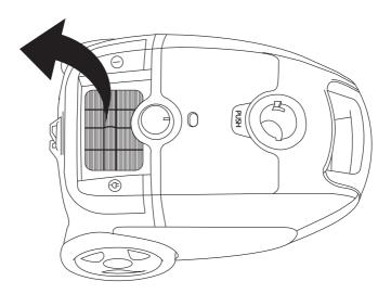
• Rimuovere il filtro di uscita e pulirlo o sostituirlo.
