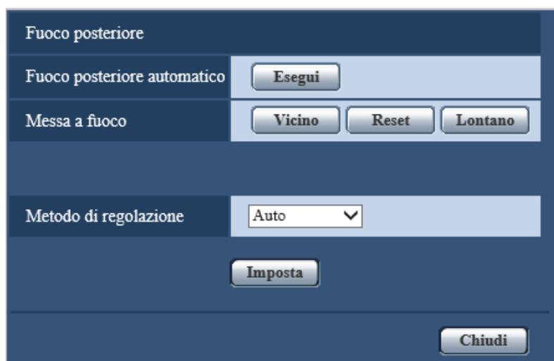
La funzione del fuoco posteriore automatico viene avviata cliccando il pulsante [Esegui] per la regolazione automatica del fuoco posteriore basata su un soggetto situato al centro dello schermo.
