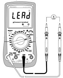
Vengono rilevati i sequenti errori di collegamento:
