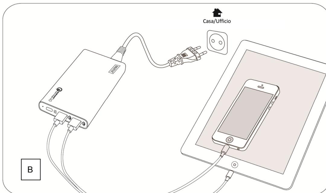
**Precauzione:** Questo adattatore supporta una potenza massima di 40 W. Se si supera tale limite, l'adattatore attiverà la protezione contro sovraccarica. Ricollegare il dispositivo per ripristinare il funzionamento regolare.
