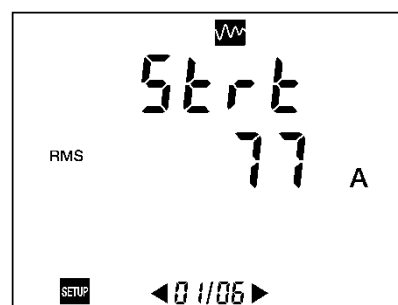
Figura 47: Visualizzazione del parametro relativo alla corrente di partenza.
