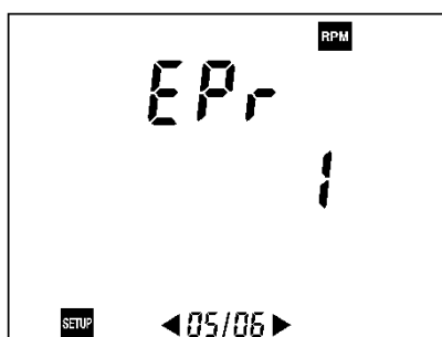
Figura 53: Visualizzazione del parametro relativo al numero di evento per giro del segnale tachimetrico.
