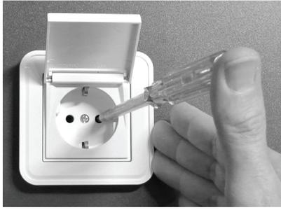
→ In questo modo è possibile, per esempio, determinare rapidamente a quale presa viene applicata la fase L.
