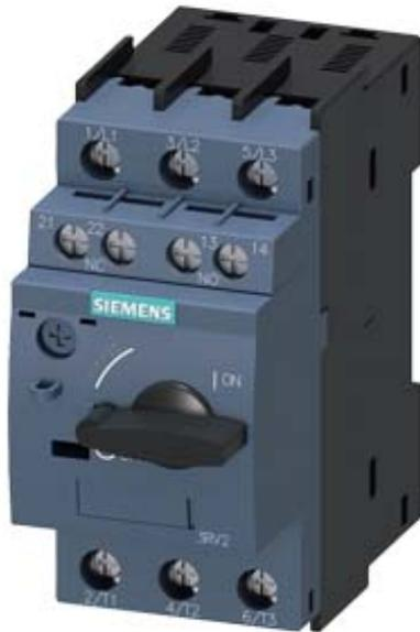
tipo speciale interruttore automatico grandezza costruttiva S00 per protezione motore, CLASS 10 sganciatore A 5,5...8 A sganciatore N 104 A morsetto a vite potere di manovra standard con blocchetto di contatti ausiliari frontale 1NO+1NC temperatura ambiente -50 °C 500 cicli di manovra
