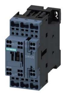
contattore ferroviario, AC-3 25 A, 11 kW / 400 V 1 NO + 1 NC AC (40-60 Hz) azionato DC, UC 24 V, 0,7-1,25\* US, con Varistore integrato, a 3 poli, grandezza costruttiva S0, morsetto a molla posizione di montaggio verticale
