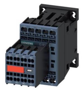
Contattore di potenza, AC-3 12 A, 5,5 kW / 400 V 2 NO+2 NC, AC 110 V, 50 Hz 120 V, 60 Hz a 3 poli, grandezza costruttiva S00 morsetto a molla Blocchetto di contatti ausiliari non rimovibile per applicazioni SUVA
