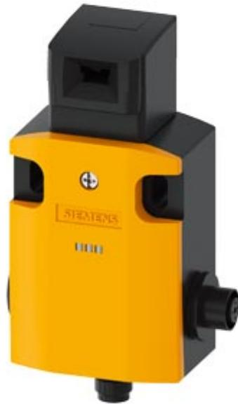
fincorsa di sicurezza con azionatore separato 5 direzioni di accostamento custodia in metallo, larghezza 56 mm ASIsafe integrato stato AS-i: 1:F-IN1, 2:F-IN2 3:AS-i/FAULT contatti ad azione lenta 1NC con connettore M12 a 4 poli canale 1 su contatto NC, canale 2 su presa M12 destra
