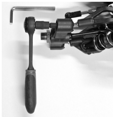
Serrare/allentare la vite senza testa (C)
