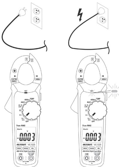
→ Per prima cosa testare sempre la funzione NCV su una fonte di tensione di CA nota per evitare rilevamenti errati. In caso di rilevazioni errate vi è il rischio di scosse elettriche. Per molti cavi, i conduttori interni sono attorcigliati. Pertanto, spostare il sensore di alcuni centimetri lungo il cavo per rilevare tutte le posizioni dei conduttori interni.
