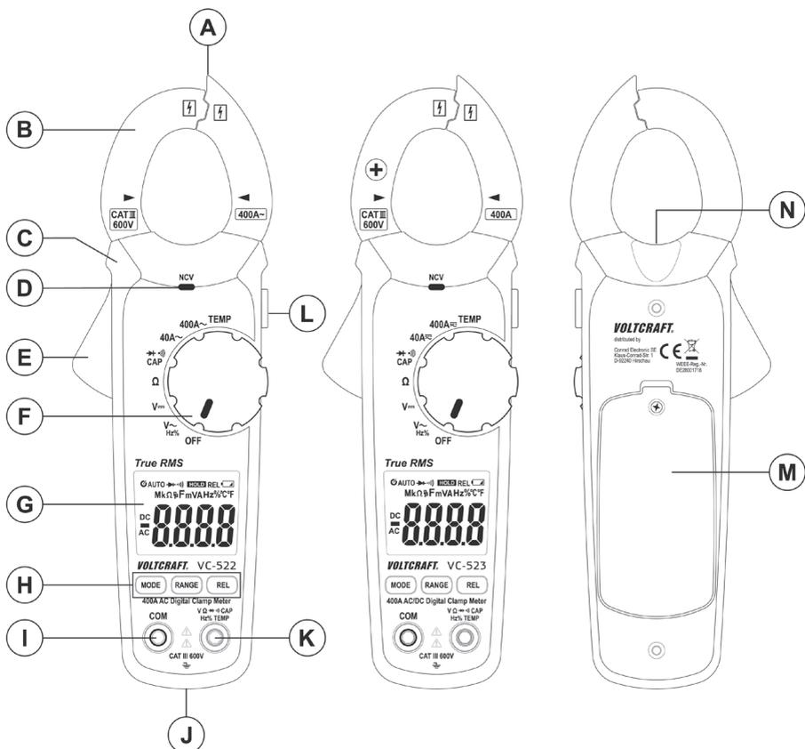
A Separatore cavo con sensore NCV integrato
