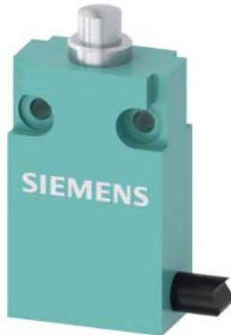
Positionsschalter in Kompaktbauform 30 mm breit mit Anschlussleitung 5 m Sprungschaltglieder 1S+1Ö mit Kuppenstößel
