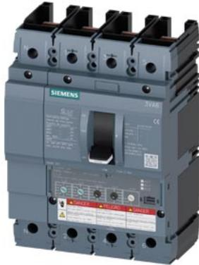
Leistungsschalter 3VA6 UL Frame 250 Schaltvermögenklasse L 150kA @ 480V 4-polig, Anlagenschutz ETU350, LSI, In=250A Überlastschutz, 100% rated Ir=100A...250A Kurzschlusschutz Isd=1,5...10 x Ir, li=10 x In N-Leiterschutz einstellbar (OFF, 50%, 100%) ohne Anschluss
