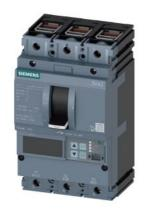
Leistungsschalter 3VA2 IEC Frame 160 Schaltvermögenklasse C lcu=110kA @ 415V 3-polig, Motorschutz ETU860M, LSIG, In=40A Überlastschutz Ir=16A...40A Kurzschlussschutz Isd=1,2..15x In, Ii=3..15x In Erdschlussschutz, abschaltbar Ig=0,4... 1 x In, tg=0,05-0,8s Klemmenanschluss
