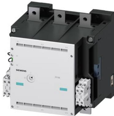
Schütz, Baugröße 14, 3-polig, AC-3, 335kW, 400/380V (690V) Hilfsschalter 44 (4NO+4NC) AC-Betätigung AC 500 bis 600V 50/60Hz
