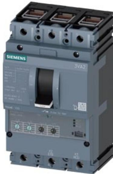
Interruttore automatico 3VA2 IEC Frame 100 Classe del potere di interruzione H Icu=85kA @ 415V a 3 poli, protezione impianto ETU350, LSI, In=100A protezione da sovraccarico Ir=40A...100A protezione da cortocircuito I<sub>sd</sub>=1,5...10 x I<sub>r</sub>, I<sub>i</sub>=12 x I<sub>n</sub> connessione a morsetto 1 blocchetto di contatti ausiliari HP 1 blocchetto di contatti di segnalazione intervento HP
