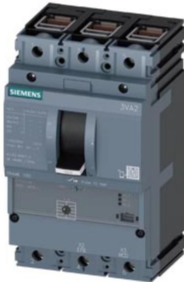
Interruttore automatico 3VA2 IEC Frame 160 Classe del potere di interruzione C Icu=110kA @ 415V a 3 poli, protezione avviatore ETU310M, I, In=100A protezione da sovraccarico Ir=40A...100A protezione da cortocircuito li=3...15 x In connessione a morsetto bobina a lancio di corrente (STL) 110 ... 127V DC, AC 50/60Hz 2 blocchetti di contatti ausiliari HQ
