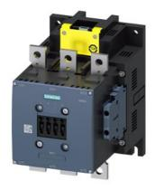
Leistungsschütz, AC-3 300 A, 160 kW / 400 V Spule AC 50/60 Hz und DC 96-127 V x (0,8-1,1) F-SPS Eingang 24 V DC 3-polig Baugröße S10 Hilfskontakte 2 S + 2  $\ddot{\text{O}}$  Hauptstr.: Schiene Steuer- und Hilfstromkreis: Schraubanschluss
