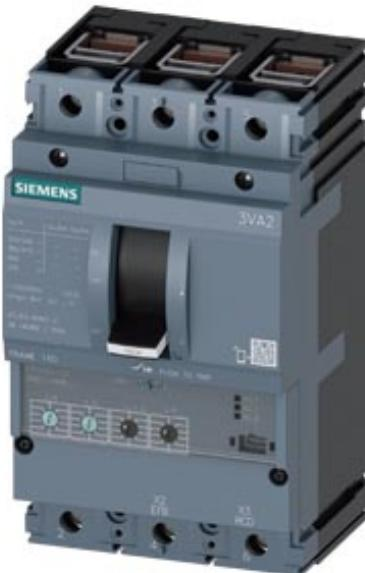
Interruttore automatico 3VA2 IEC Frame 160 Classe del potere di interruzione H  $I_{cu}=85\text{kA}$  @ 415V a 3 poli, protezione impianto ETU350, LSI,  $I_{n}=100\text{A}$  protezione da sovraccarico  $I_{r}=40\text{A}...100\text{A}$  protezione da cortocircuito  $I_{sd}=1,5...10 \times I_r$ ,  $I_{i}=12 \times I_n$  connessione a morsetto bobina di minima tensione (UVR) DC 24 V 2 blocchetti di contatti ausiliari HQ
