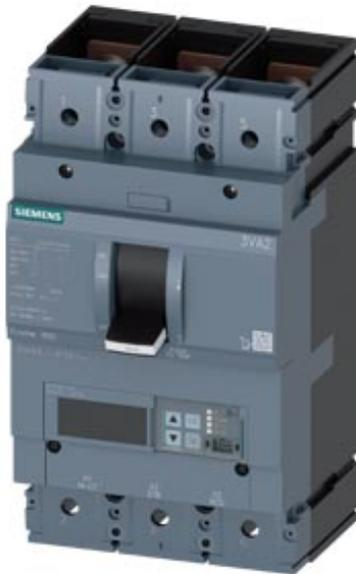
Interruttore 3VA2 IEC Frame 400 Classe del potere di interruzione H Icu=85kA @ 415V a 3 poli, protezione impianto ETU550, LSI, In=400A protezione da sovraccarico Ir=160A...400A protezione da cortocircuito I<sub>sd</sub>=0,6...10 x I<sub>n</sub>, I<sub>i</sub>=1,5 x I<sub>n</sub> protezione del conduttore di neutro opzionale con trasformatore di corrente, fino a 160% attacco piatto a vite bobina a lancio di corrente (STL) 110 ... 127V DC, AC 50/60Hz 2 blocchetti di contatti ausiliari HQ
