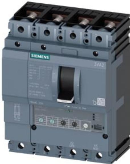
Interruttore 3VA2 IEC Frame 250 Classe del potere di interruzione M Icu=55kA @ 415V a 4 poli, protezione impianto ETU350, LSI, In=250A protezione da sovraccarico Ir=100A...250A protezione da cortocircuito I<sub>sd</sub>=1,5...10 x I<sub>r</sub>, I<sub>i</sub>=10 x I<sub>n</sub> protezione del conduttore di neutro impostabile (OFF, 50%, 100%) attacco piatto a vite 2 blocchetti di contatti ausiliari HP 1 blocchetto di contatti di segnalazione intervento HP
