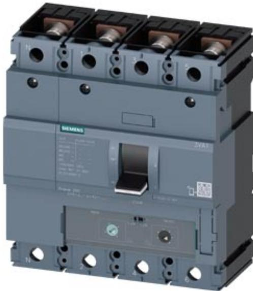
Interruttore automatico 3VA1 IEC Frame 250 Classe del potere di interruzione H Icu=70kA @ 415V a 4 poli, protezione impianto TM240, ATAM, In=200A protezione da sovraccarico Ir=140 A ... 200 A protezione da cortocircuito Ii=5 ... 10 x In conduttore di neutro non protetto attacco piatto a vite bobina a lancio di corrente (STL) DC 220 ... 250 V; 208-277V AC 2 blocchetti di contatti ausiliari HQ
