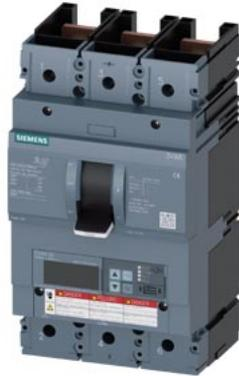
Leistungsschalter 3VA6 UL Frame 600 Schaltvermögenklasse L 150kA @ 480V 3-polig, Anlagenschutz ETU550, LSI, In=400A Überlastschutz Ir=160A...400A Kurzschlusschutz Isd=0,6..10x In, li=1,5..12x In N-Leiterschutz optional mit externem Stromwandler, bis 160% ohne Anschluss
