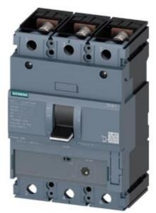
Interruttore automatico 3VA1 IEC Frame 250 Classe del potere di interruzione H Icu=70kA @ 415V a 3 poli, protezione avviatore TM120M, AM, In=200A senza protezione da sovraccarico protezione da cortocircuito Ii=6 ... 14 x In attacco piatto a vite bobina a lancio di corrente (STL) DC 12-30 V; AC 24 V 50/60 HZ 2 blocchetti di contatti ausiliari HQ 1 blocchetto di contatti di segnalazione intervento HQ
