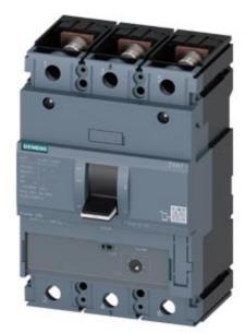
Interruttore automatico 3VA1 IEC Frame 250 Classe del potere di interruzione H Icu=70kA @ 415V a 3 poli, protezione avviatore TM120M, AM, In=200A senza protezione da sovraccarico protezione da cortocircuito Ii=6 ... 14 x In attacco piatto a vite bobina a lancio di corrente (STL) 110 ... 127V DC, AC 50/60Hz 2 blocchetti di contatti ausiliari HQ
