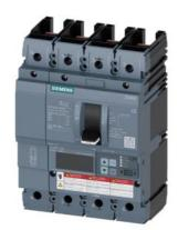
Leistungsschalter 3VA6 UL Frame 150 Schaltvermögenklasse H 65kA @ 480V 4-polig, Anlagenschutz ETU860, LSIG, In=150A Überlastschutz Ir=60A...150A Kurzschlussschutz Isd=0,6..10x In, Ii=1,5..10x In N-Leiterschutz einstellbar (OFF, bis 100%) Erdschlussschutz Ig=0,2...1 x In=tg=0,05-0,8s ohne Anschluss
