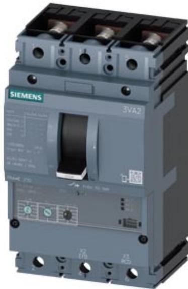
Interruttore automatico 3VA2 IEC Frame 250 Classe del potere di interruzione M Icu=55kA @ 415V a 3 poli, protezione motore ETU350M, LSI, In=200A protezione da sovraccarico Ir=80A...200A protezione da cortocircuito I<sub>sd</sub>=3...15 x I<sub>r</sub>, I<sub>i</sub>=15 x I<sub>n</sub> attacco piatto a vite 1 blocchetto di contatti ausiliari HP 1 blocchetto di contatti di segnalazione intervento HP
