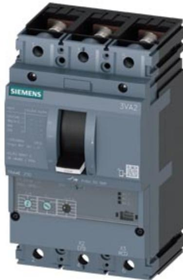
Interruttore automatico 3VA2 IEC Frame 250 Classe del potere di interruzione M Icu=55kA @ 415V a 3 poli, protezione motore ETU350M, LSI, In=200A protezione da sovraccarico Ir=80A...200A protezione da cortocircuito I<sub>sd</sub>=3...15 x I<sub>r</sub>, I<sub>i</sub>=15 x I<sub>n</sub> attacco piatto a vite 2 blocchetti di contatti ausiliari HQ 1 blocchetto di contatti di segnalazione intervento HQ
