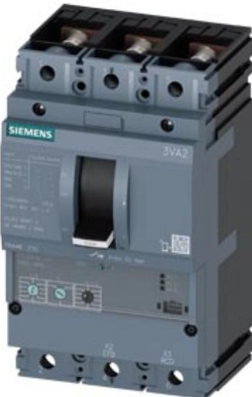
Interruttore automatico 3VA2 IEC Frame 250 Classe del potere di interruzione M Icu=55kA @ 415V a 3 poli, protezione motore ETU350M, LSI, In=200A protezione da sovraccarico Ir=80A...200A protezione da cortocircuito Isd=3...15 x Ir, Ii=15 x In attacco piatto a vite bobina a lancia di corrente (STL) DC 12-30V, AC 24V 50/60Hz 2 blocchetti di contatti ausiliari HQ 1 contatto di segnalazione intervento HQ 1 blocchetto di contatti di segnalazione intervento di protezione
