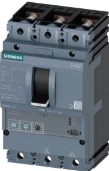
Interruttore automatico 3VA2 IEC Frame 250 Classe del potere di interruzione M Icu=55kA @ 415V a 3 poli, protezione motore ETU350M, LSI, In=200A protezione da sovraccarico Ir=80A...200A protezione da cortocircuito Isd=3...15 x Ir, Ii=15 x In attacco piatto a vite bobina a lancio di corrente (STL) DC 220 ... 250 V, 208-277V AC 2 blocchetti di contatti ausiliari HQ 1 contatto di segnalazione intervento HQ 1 blocchetto di contatti di segnalazione intervento di protezione
