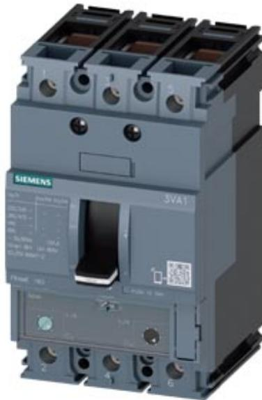
interruttore automatico 3VA1 IEC Frame 160 classe del potere di interruzione M Icu=55kA @ 415V a 3 poli, protezione impianto TM240, ATAM, In=25A protezione da sovraccarico Ir=18 A ... 25 A protezione da cortocircuito li=6,4...12,8 x In connessione a morsetto 2 blocchetti contatti aus. HQ
