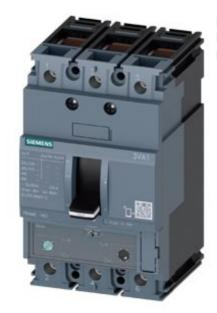
interruttore automatico 3VA1 IEC Frame 160 classe del potere di interruzione M Icu=55kA @ 415V a 3 poli, protezione impianto TM240, ATAM, In=25A protezione da sovraccarico Ir=18 A ... 25 A protezione da cortocircuito Ii=6,4...12,8 x In connessione a morsetto bobina di minima tensione (UVR) AC 120 ... 127 V 50/60 Hz 2 blocchetti contatti aus. HQ
