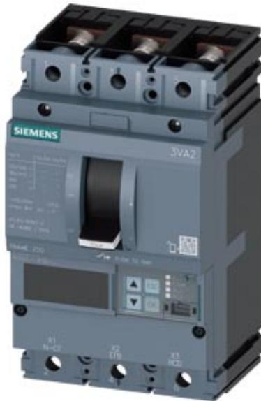
Interruttore 3VA2 IEC Frame 250 Classe del potere di interruzione H Icu=85kA @ 415V a 3 poli, protezione impianto ETU550, LSI, In=250A protezione da sovraccarico Ir=100A...250A protezione da cortocircuito I<sub>sd</sub>=0,6..10x I<sub>n</sub>, I<sub>i</sub>=1,5..10x I<sub>n</sub> protezione del conduttore di neutro opzionale con trasformatore di corrente attacco piatto a vite bobina di minima tensione (UVR) AC 120 ... 127 V 50/60 Hz 2 blocchetti di contatti ausiliari HQ
