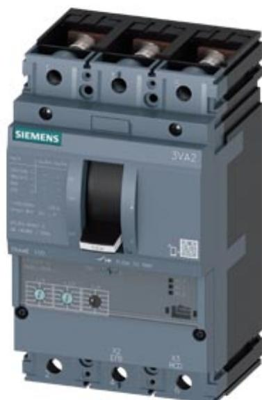
Interruttore automatico 3VA2 IEC Frame 100 Classe del potere di interruzione H  $I_{cu}=85kA @ 415V$  a 3 poli, protezione impianto ETU320, LI,  $I_n=100A$  protezione da sovraccarico  $I_r=40A...100A$  protezione da cortocircuito  $I_i=1,5...12 \times I_n$  attacco piatto a vite bobina a lancio di corrente (STL) 110 ... 127V DC, AC 50/60Hz 2 blocchetti di contatti ausiliari HQ 1 blocchetto di contatti di segnalazione intervento HQ
