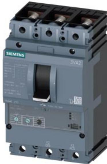
Interruttore automatico 3VA2 IEC Frame 250 Classe del potere di interruzione C Icu=110kA @ 415V a 3 poli, protezione motore ETU350M, LSI, In=200A protezione da sovraccarico Ir=80A...200A protezione da cortocircuito I<sub>sd</sub>=3...15 x I<sub>r</sub>, I<sub>i</sub>=15 x I<sub>n</sub> attacco piatto a vite bobina a lancio di corrente (STL) DC 220 ... 250 V, 208-277V AC 2 blocchetti di contatti ausiliari HQ
