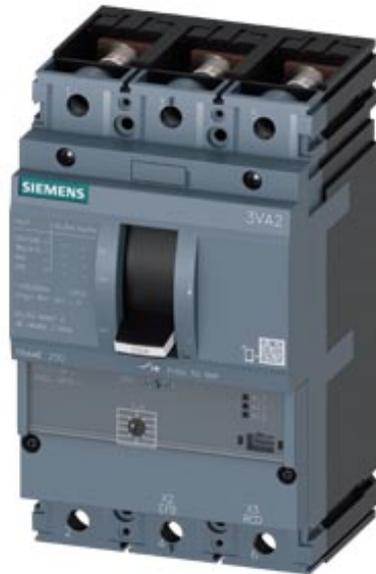
Interruttore automatico 3VA2 IEC Frame 250 Classe del potere di interruzione C Icu=110kA @ 415V a 3 poli, protezione avviatore ETU310M, I, In=200A protezione da sovraccarico Ir=80A...200A protezione da cortocircuito Ii=3...15 x In attacco piatto a vite bobina di minima tensione (UVR) DC 24 V
